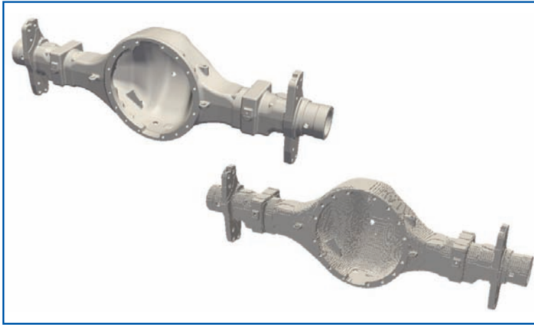
Figura 2 Modello STL del componente e relativa mesh "voxelizzata".
