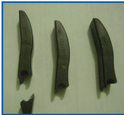
Rottura riscontrata sul componente in esame.
