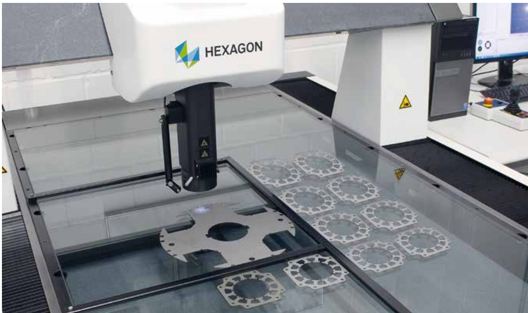
Verifica ottica dei lamierini dei motori elettrici utilizzando sistemi Hexagon
